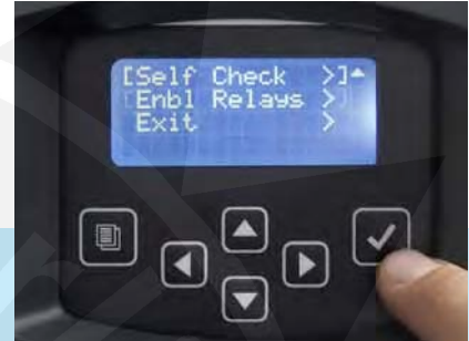
Das Service-Diagnose-Programm überprüft Geräteteile auf mögliche Defekte.
