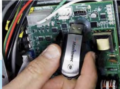
Dank der IceConnect™ USB- und RS485-Schnittstellen können Gerätedaten für Service- und Wartungsarbeiten einfach
