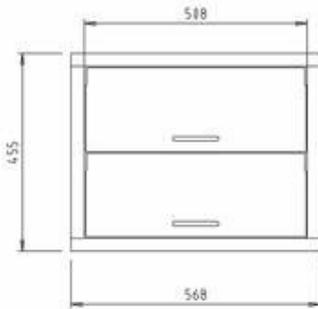
Umlaufendes Rahmenprofil 30mm aus CNS, 2 Klappen aus Kunststoff, Griff verchromt.
