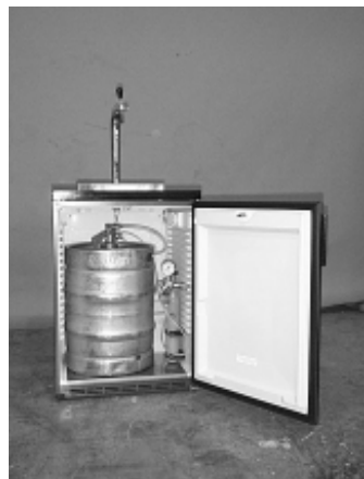
Zapfanlage montiert mit 50 lt. Faß
