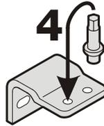
5. Bolzen am Gerät oben umsetzen.
