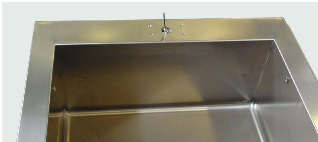
Collegare la sonda con il cavo elettrico della lampada tramite nastro adesivo.
