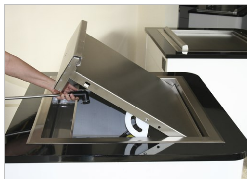
Abb. 6.11 Verdampfer mit Brause (oder weicher Bürste) reinigen.
