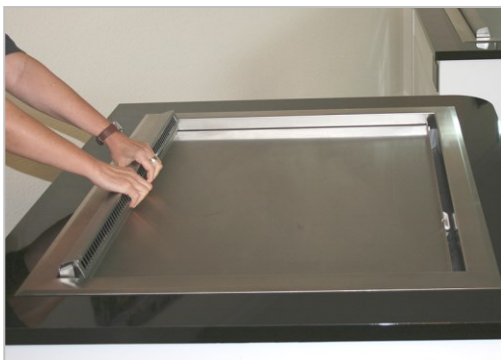
Abb. 6.1. Beidhändig die Luftausblasdüse mit der Warenauslage in der Mitte fassen ...
