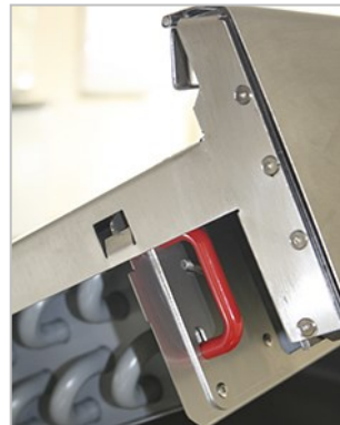
Abb. 6.17 Sichern: Beidseitig die roten Griffe nach unten schieben.
