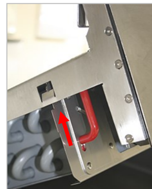
Abb. 6.9 Beidseitig die roten Griffe nach oben schieben und entsichern.
