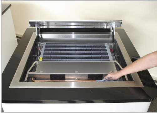
Abb. 6.14 Hinteren Wannenbereich reinigen.
