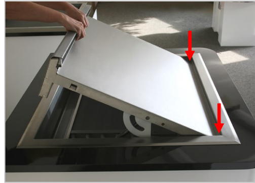
Abb. 6.15 Nach der Reinigung die Warenauslage beidseitig anheben und vorsichtig zurückschwenken. Darauf achten, dass die seitlichen Führungen der Warenauslage auf den Lagerbolzen aufliegen.
