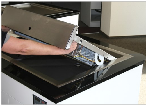
Abb. 6.16 Schließen: Verdampfer beidseitig an den Griffen haltend hochschwenken und einrasten.
