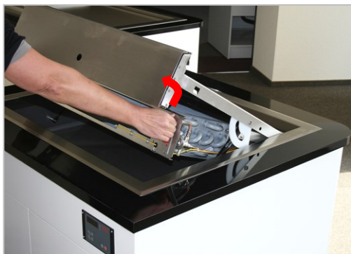
Abb. 6.10 Griffe zur Verdampfermitte drehen (aushaken). Den Verdampfer auf dem Wannenboden ablegen.
