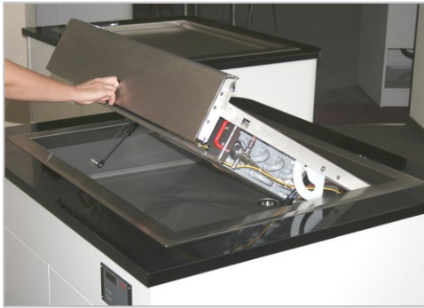
Abb. 6.3. In das Griffloch der Reinigungsblende greifen und aufklappen.
