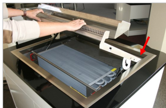
Abb. 6.19 Nach der Reinigung die Warenauslage beidseitig anheben und vorsichtig zurückschwenken. Darauf achten, dass die seitlichen Führungen der Warenauslage auf den Lagerbolzen aufliegen. Zum Schluss die Warenauslage schließen.
