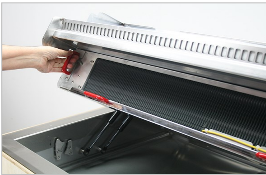
Abb. 6.14 Hebel nach innen drehen und zur Verdampfermitte schwenken (aushaken) ...
