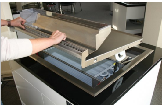
Abb. 6.16 Zunächst Zustand MOVE-DOWN herstellen (siehe Abb. 6.10 – 6.11); dann die Warenauslage gleichmäßig mit beiden Händen zur Bedienseite schwenken
