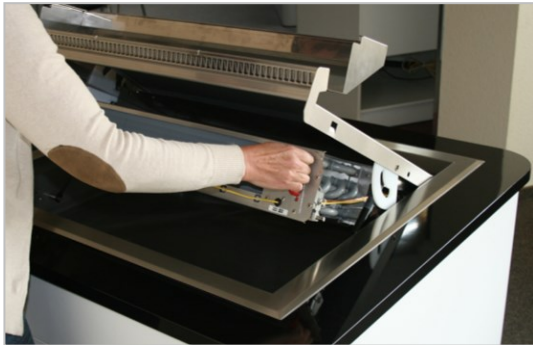
Abb. 6.20 Schließen: Verdampfer beidseitig an den Griffen haltend hochschwenken und einrasten.
