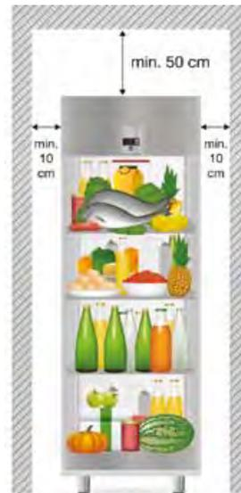
Installation der Maschine:
