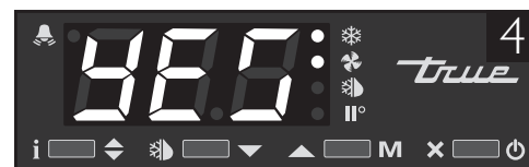
Siehe Bilder 4: Wenn „ja“ auf dem Bildschirm erscheint, ist der Regler gesperrt.
