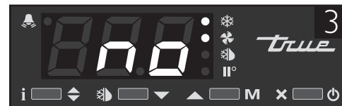
Siehe Bilder 3: Wenn „nein“ auf dem Bildschirm erscheint, ist der Regler entsperrt.
