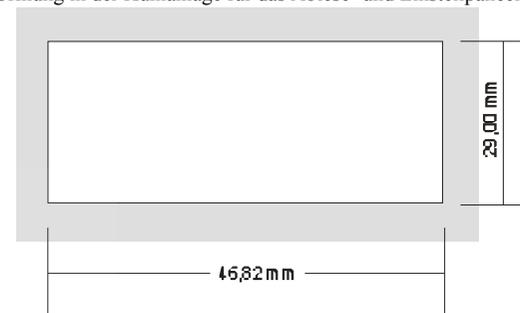
2. Das Paneel in die vorbereitete Öffnung einsetzen.
