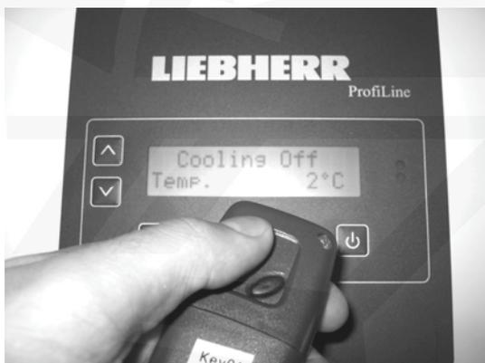
**D3.** Menü aktivieren: Schlüssel auf Elektronik richten und Taste 1 für 3 Sekunden drücken → ein Piepton wird ausgegeben → „UpLoad Par“ wird angezeigt.
