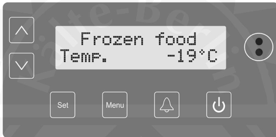
Die Infrarotschnittstelle ist in obiger Grafik eingekreist. Um eine schnelle Datenübertragung zu gewährleisten, muss der Schlüssel in der richtigen Position zum Regler stehen: Optimal ca. 50 cm entfernt und im 90°-Winkel zum Display genau vor der Schnittstelle.
