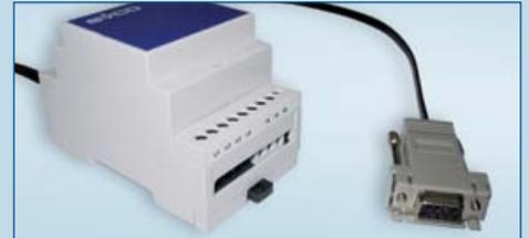
Die RS 485 Busverbindung besteht aus abgeschirmten Datenkabeln, zum Beispiel vom Typ LiYCY 2 x 0,14 mm<sup>2</sup>. Die maximal erreichbare Länge der Datenleitung beträgt 500 m, ist jedoch von der Qualität der eingesetzten Komponenten abhängig. Es können maximal 20 Geräte in Serie geschaltet werden.
