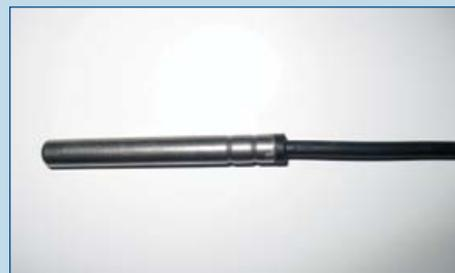
Aufgrund möglicher Toleranzen des optionalen Produkt-Temperaturfühlers kann die angezeigte Produkt-Temperatur von der Produktfühlertemperatur abweichen. Mit Hilfe der neuen Kalibrationsfunktion kann die angezeigte Produkttemperatur mit der Produktfühlertemperatur abgeglichen werden. Der Korrekturwert zur Kompensation der Differenzen kann in 0,1°C Schritten eingestellt werden.
