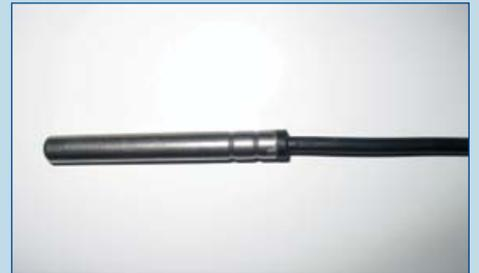
Aufgrund möglicher Toleranzen des optionalen Produkt-Temperaturfühlers kann die angezeigte Produkt-Temperatur von der Produktfühlertemperatur abweichen. Mit Hilfe der neuen Kalibrationsfunktion kann die angezeigte Produkttemperatur mit der Produktfühlertemperatur an bis zu drei Temperaturpunkten abgeglichen werden. Der Korrekturwert zur Kompensation der Differenzen kann in 0,1°C Schritten eingestellt werden.
