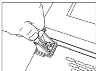
10. Fixer la charnière inférieure du côté opposé.
