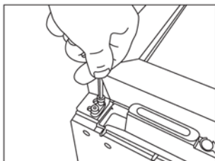
5. Læg apparatet ned på ryggen og fjern tophængslet.
