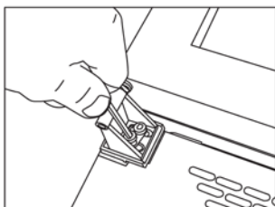
10. Fastgør bundhængslet på den anden side.
