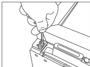
5. Legen Sie das Gerät auf den Rücken und entfernen Sie das obere Scharnier mit einem Sechskantschlüssel.
