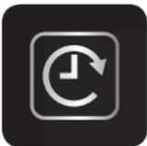
Mit „**Pause**“ lässt sich die Eisproduktion für vier, zwölf oder 24 Stunden unterbrechen. So können die Produktionsmenge besser gesteuert und Wasser- sowie Energiekosten weiter gesenkt werden. Nach Ablauf der eingestellten Produktionspause nimmt der Eisbereiter die Arbeit automatisch wieder auf. Diese Funktion ist ideal für Tage mit kurzen Öffnungszeiten oder während Schließtagen.
