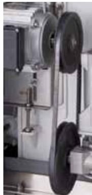
Riemenscheiben & Riemensystem zum Anpassen der Eisdicke
