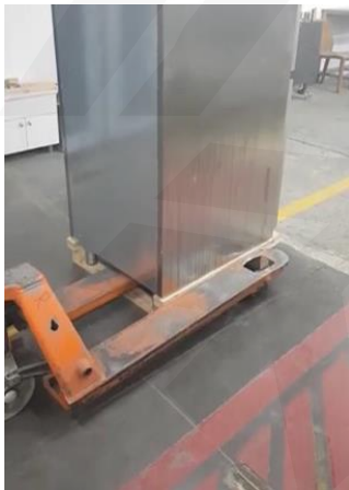
Abb. 10-11-12: Mit Hilfe eines Hubwagens oder durch äußerst vorsichtiges einseitiges Anheben bzw. Kanten des Gerätes - Achtung: kopflastig! - kann die Palette nun unter dem Gerät herausgezogen werden. Hierzu nicht zwischen Gerät und Palette oder unter die Palette fassen Quetschgefahr!
