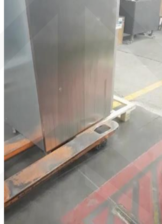
Abb. 10-11-12: Mit Hilfe eines Hubwagens oder durch äußerst vorsichtiges einseitiges Anheben bzw. Kanten des Gerätes - Achtung: kopflastig! - kann die Palette nun unter dem Gerät herausgezogen werden. Hierzu nicht zwischen Gerät und Palette oder unter die Palette fassen Quetschgefahr!
