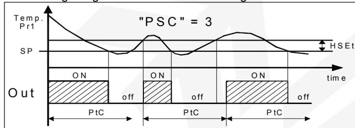
Steht der Parameter "PtC" = 0, ist diese Funktion deaktiviert. Im Parameter "LCt" lässt sich eine Mindesteinschaltzeit für den Ausgang vorgeben, damit zu kurze Verdichtereinschaltungen vermieden werden.
