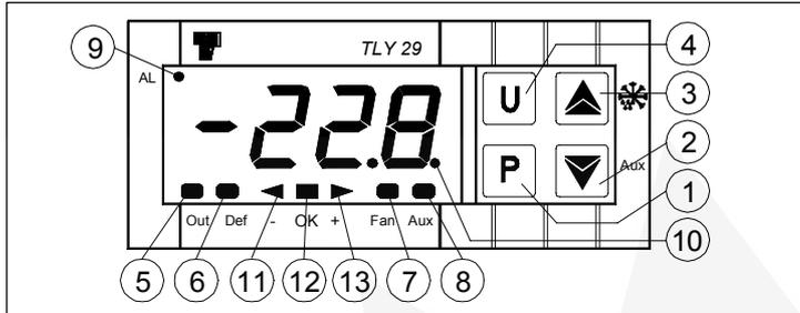
**1 - Taste P:** Wird zur Eingabe des Sollwertes und zur Programmierung der Betriebsparameter verwendet
