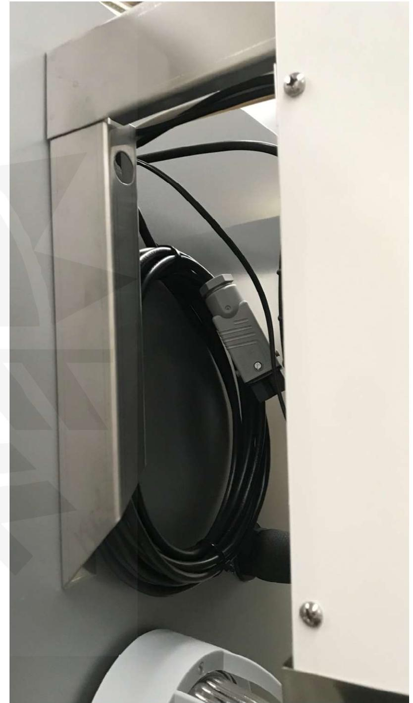
**Verbinden sie das Lichtsensor Kabel
