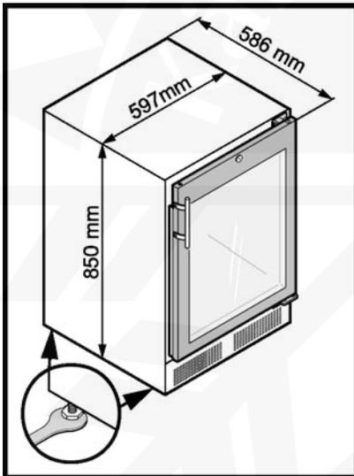
Unebenheiten mit beiliegendem Gabelschlüssel über die Stellfüße ausgleichen.
