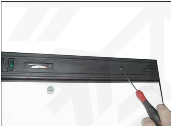
3. Abdeckkappen oben abnehmen. Schrauben lösen. Obere Kopfblende abnehmen-
