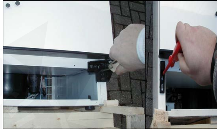
2. Die Schrauben mit einem Kreuzschraubenzieher lösen. Scharnier abnehmen. Links ebenso.
