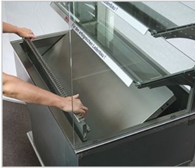
Abb. 6.13 Kundenseitige Luftansaugblende entnehmen (bzw. einsetzen).
