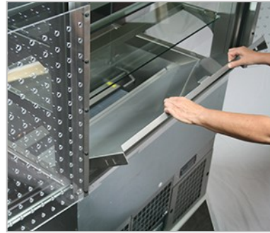
Abb. 6.14 Warenauslage zur Bedienseite herausziehen und auf dem Wannenrand ablegen.
