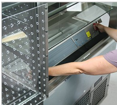
Abb. 6.11 Verdampfer aushaken und auf dem Wannenboden ablegen.
