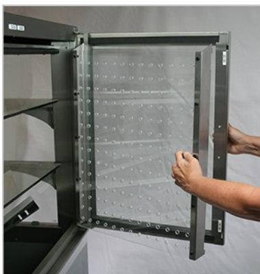
Abb. 6.3 In die runde Öffnung greifen und die gelochte Blende abklappen.
