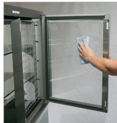
Abb. 6.4 Die Innenflächen der Drehtür und der Luftverteiblende können nun gereinigt werden.
