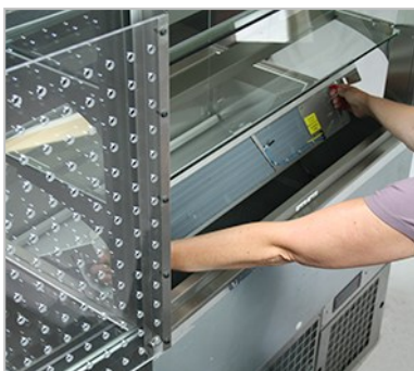
Abb. 6.17 Schließen: Verdampfer beidseitig an den Griffen haltend hochschwenken und einrasten.
