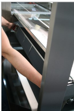
Abb. 6.14 Schließen: Verdampfer beidseitig an den Griffen haltend hochschwenken und einrasten.
